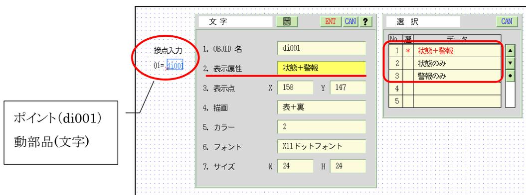
図 5.3.10 監視パネル CAD の動部品(文字)の表示属性の設定
